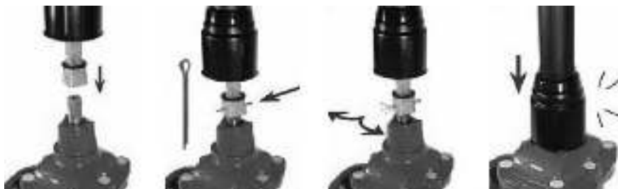
Рис. 4 Порядок установки телескопического штока на задвижку.
